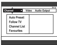
Dieser Recorder wählt während der Erstinstallation alle verfügbaren analogen TV-Sender aus. Sie können diesen Vorgang jedoch wiederholen, wenn in Ihrer Region weitere Sender verfügbar werden oder Sie den Recorder erneut installieren.
