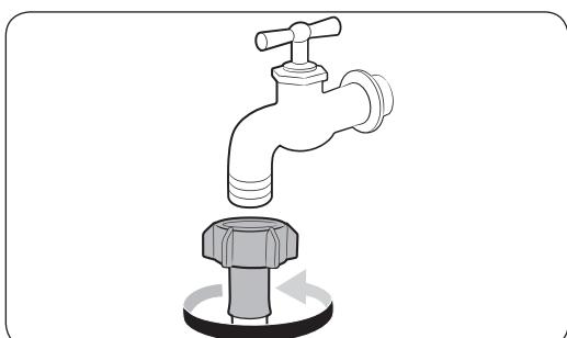
7. Se si usa un rubinetto con attacco filettato, utilizzare il relativo adattatore fornito per collegare il rubinetto come indicato.
