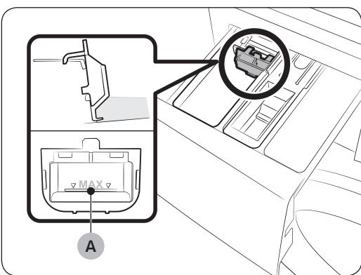
Inserire per prima la guida per liquidi in dotazione nel **II** comparto lavaggio principale. Quindi, versare il detersivo liquido nella guida al di sotto della linea max (A).
