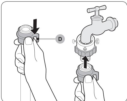
6. Tenendo abbassata la **parte (D)**, collegare il tubo di carico dell'acqua all'adattatore. Quindi rilasciare la **parte (D)**. Quando il tubo si innesta nell'adattatore si avverte un clic.
