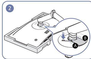
Inserire lo strumento di disassemblaggio dedicato nelle linguette **A** e **B**, quindi utilizzarlo per fare leva e sollevare il COPERTO INFERIORE.
