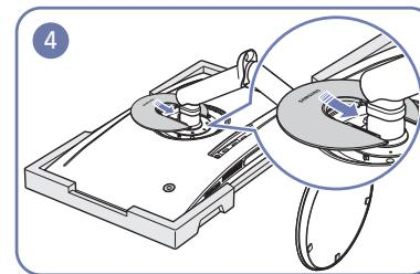
Nella parte posteriore del monitor, allineare e spingere il COPERCHIO SUPERIORE nella scanalatura seguendo la direzione indicata dalla freccia.
