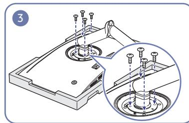
Utilizzare le viti per fissare saldamente il piedistallo.
