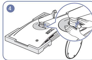
Nella parte posteriore del monitor, sollevare con le dita il COPERTO SUPERIORE nella direzione indicata dalle frecce, come mostrato in figura.
