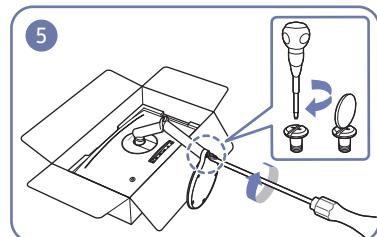
Fissare la base del piedistallo al collo, quindi avvitare le due viti alla base per fissarla saldamente.
