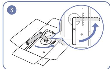
Ruotare il connettore del piedistallo di 90° in senso antiorario e posizionare la parte preposta al collegamento sul bordo della confezione.
