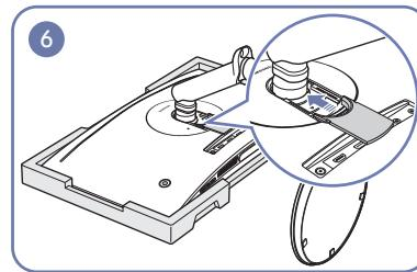
Nella parte posteriore del monitor, allineare e spingere il COPERCHIO INFERIORE nella scanalatura seguendo la direzione indicata dalla freccia.
